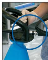
6. Le pistolet à eau (article n° 93209 ou 93219) est raccordé à l'embout de l'injecteur.
