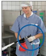
8. Wasserhahn öffnen und Schaumproduktion starten indem Sie die Pistole betätigen.
