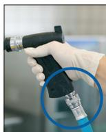
7. Vandslange med 1/2" lynkobling (varenr. 0702) sættes på pistolens nippel.
