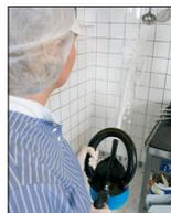
9. Расстояние от соплового отверстия инжектора до очищаемой поверхности должно составлять не менее 0,5 метра.
