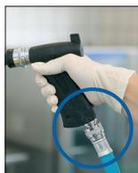
7. Vattenslang med 1/2" snabbkoppling placeras på pistolnippeln.
